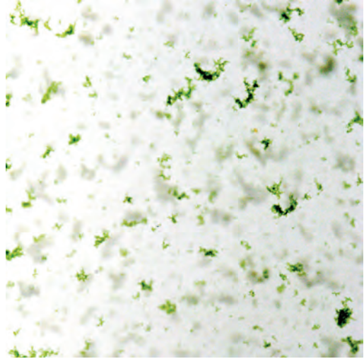
Obr. 7.1: Surový snímek suspenze agregátů tvořených AOM sinice Microcystis aeruginosa a železitým koagulačním činidlem, připravených v Taylorově–Couetteově reaktoru při G = 20 \text{ s}^{-1}
