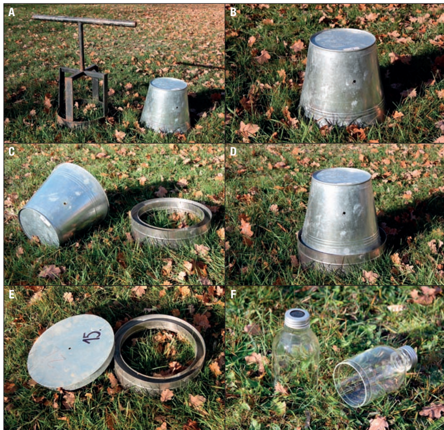
Obr. 3.1 Statické komory různé konstrukce. A. Nejjednodušší verze komory: plechový kbelík o objemu cca 16 dm 3 připravený k instalaci. Pomocí robustního kovového vrtáku (vlevo; viz také obr. 3.2) se do půdy vyřízne cca 5 cm hluboká rýha o průměru shodném s průměrem širší, otevřené strany kbelíku. Do rýhy se poté nasadí kbelík. B. Komora je připravena k měření, zbývá do otvoru ve stěně zatlačit pryžové septum umožňující odběr plynů z komory. C. Tentýž kbelík připravený k nasazení na bázi komory (vpravo) předem zapravenou do půdy. Dvojitý lem na bázi se naplní vodou, která utěsní spojení mezi bází a vrchní částí komory (kbelíkem). D. Komora připravená k měření. E. Komoru tvoří stejná báze jako v případě C–D, ale místo kbelíku se nasazuje plechové víko (vlevo od báze). To umožní podstatně zmenšit vnitřní objem komory a učinit měření emisí citlivější. F. Skleněné komory tvořené lahvemi o objemu cca 0,6 dm 3 s upraveným dnem (je vidět vpravo). Láhev se zatlačí do půdy (vlevo) a plyny se odebírají přes pryžovou zátku (foto Miloslav Šimek)
